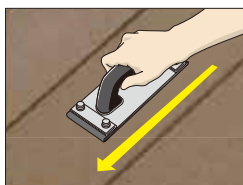
長手方向に沿って一方方向にサンドペーパーで擦ります。
